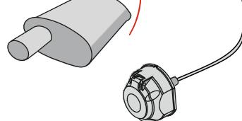
Монтаж кабеля производите на расстоянии более 15 см от выхлопной трубы.
