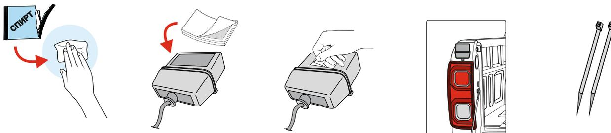
1. Перед установкой обезжирить поверхность блока и кузов автомобиля.
