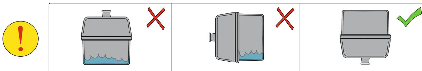
Блок необходимо установить герметичным чехлом вниз, чтобы избежать попадание конденсата в плату устройства.
