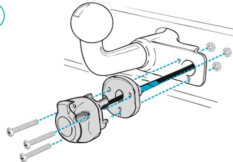
Закрепите розетку и пыльник на монтажной поверхности.
