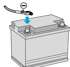
После всех проведенных работ подключите минусовую клемму аккумулятора, преимущественно руководствуйтесь рекомендациями производителя автомобиля.
