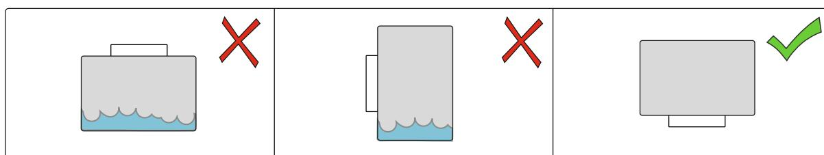
Блок устанавливать строго разъемом вниз во избежание скопления конденсата.
