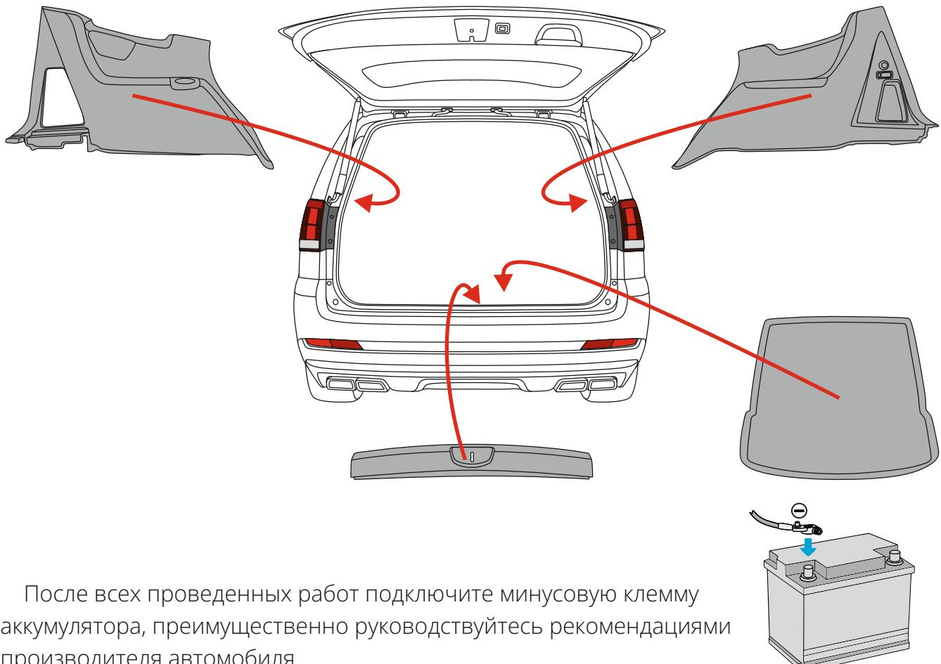
После всех проведенных работ подключите минусовую клемму аккумулятора, преимущественно руководствуйтесь рекомендациями производителя автомобиля.
