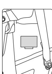
5. Установить блок в подготовленное место на кузове автомобиля.
