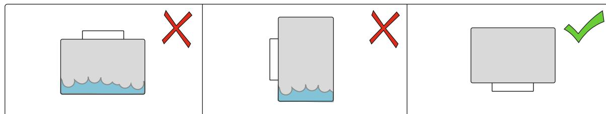
Блок необходимо установить герметичным чехлом вниз, чтобы избежать попадание конденсата в плату устройства.
