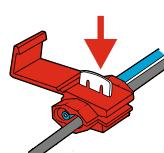
4. Задавите металлическую часть «зажим» в тело провода, не повредив медную жилу кабеля.
