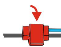
5. Зафиксируйте «зажим» сверху пластиковым изолятором до щелчка.
