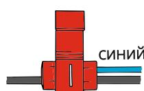
3. Установите в ответвитель синий провод «F» из комплекта и провод автомобиля, определенный в п. 1 данного раздела.
