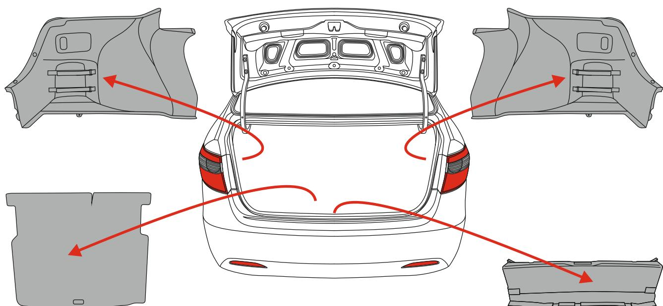
Элементы обшивки, которые рекомендуем демонтировать перед установкой комплекта проводки.
