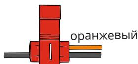
3. Установите в ответвитель оранжевый провод из комплекта и провод автомобиля, определенный в п. 1 данного раздела.
