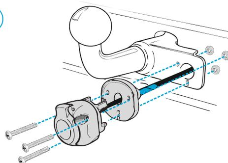
Закрепите розетку и пыльник на монтажной поверхности.
