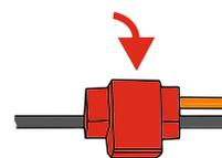
5. Зафиксируйте «зажим» сверху пластиковым изолятором до щелчка.
