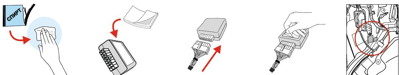
1. Предварительно обезжирить поверхность блока и подготовленное место на кузове автомобиля.
