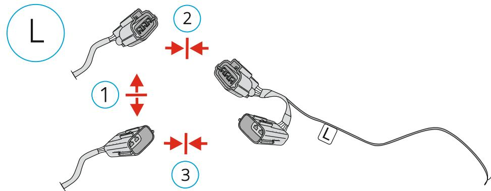
Соедините колодки до щелчка, в порядке, указанном на рисунке, надежно закрепите.
