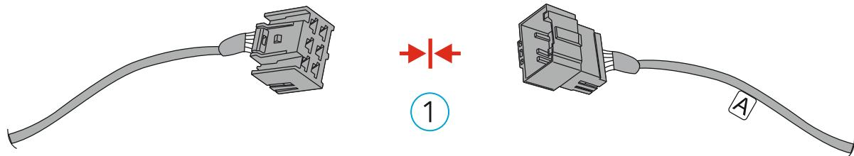
Соедините колодку из комплекта до щелчка в порядке, указанном на рисунке.
