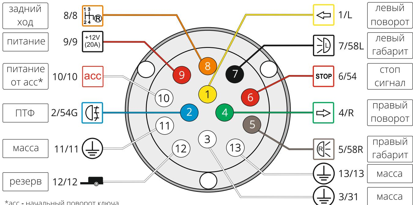
\*acc - начальный поворот ключа зажигания автомобиля
