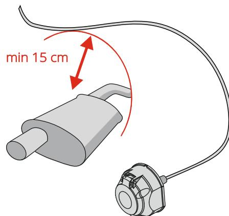
Монтаж кабеля производите на расстоянии более 15 см от выхлопной трубы.
