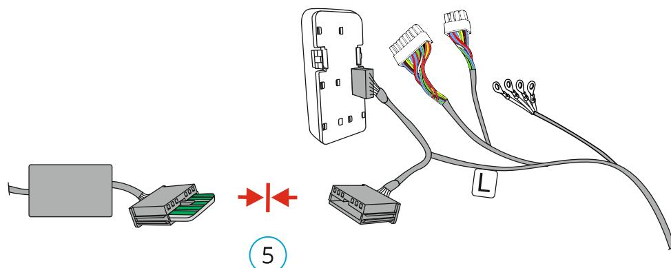
5. Соедините ответную часть перемычки с колодкой из комплекта в порядке, как указано на рисунке.
