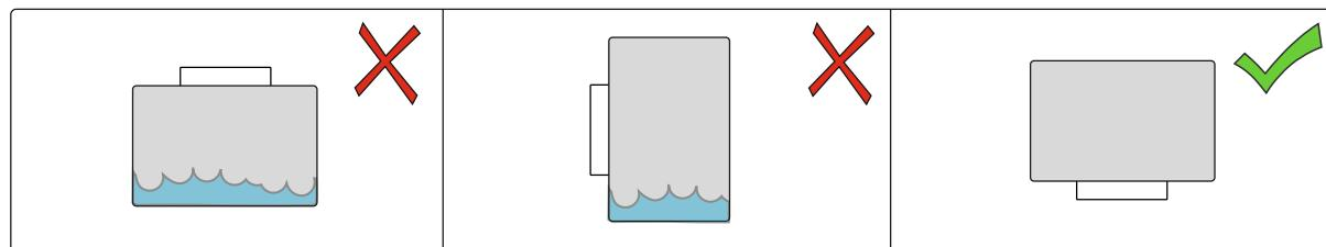
Блок необходимо установить герметичным чехлом вниз, чтобы избежать попадание конденсата в плату устройства.
