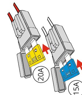
1. Возьмите провод питания и провод выходящий из держателя предохранителя.
