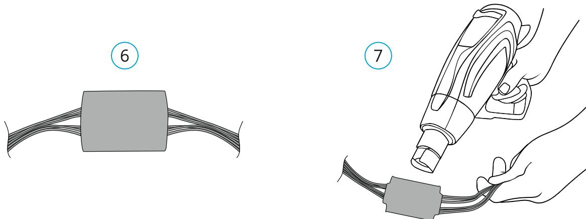
6. Установите термоусадочную трубку так, чтобы она закрывала колодки с двух сторон.
