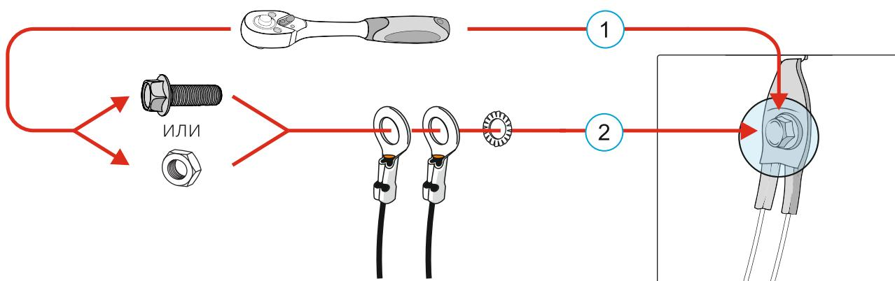
При подключении клеммы «масса» убедитесь, что рекомендуемое место установки не имеет следов коррозии и окисления, а также прочих загрязнений.
