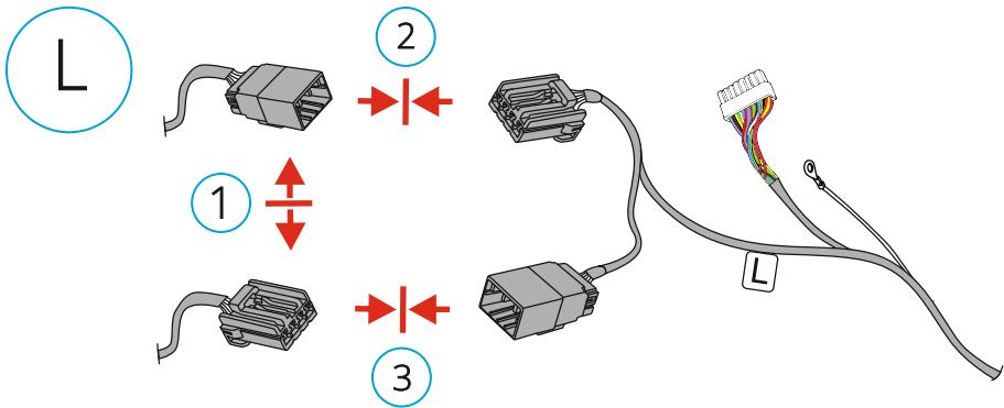
Соедините колодки до щелчка, в порядке, указанном на рисунке, надежно закрепите.
