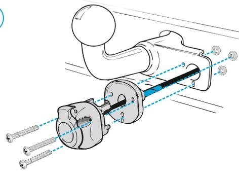
Закрепите розетку и пыльник на монтажной поверхности.
