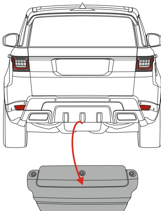
Элементы обшивки, которые рекомендуем демонтировать перед установкой комплекта проводки.
