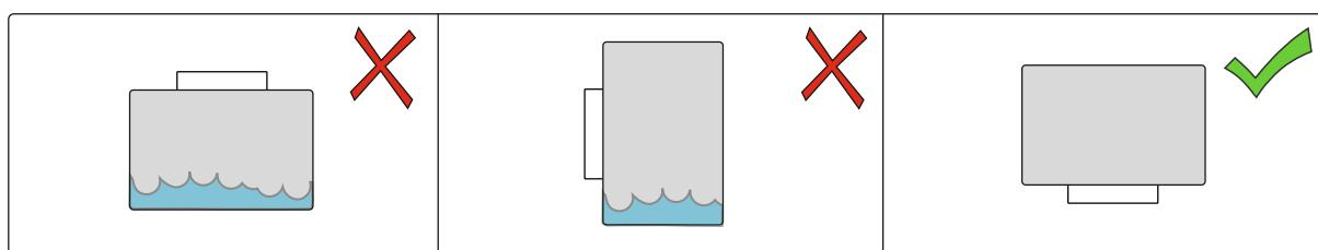
Блок устанавливать строго вниз разъемом во избежание скопления конденсата.
