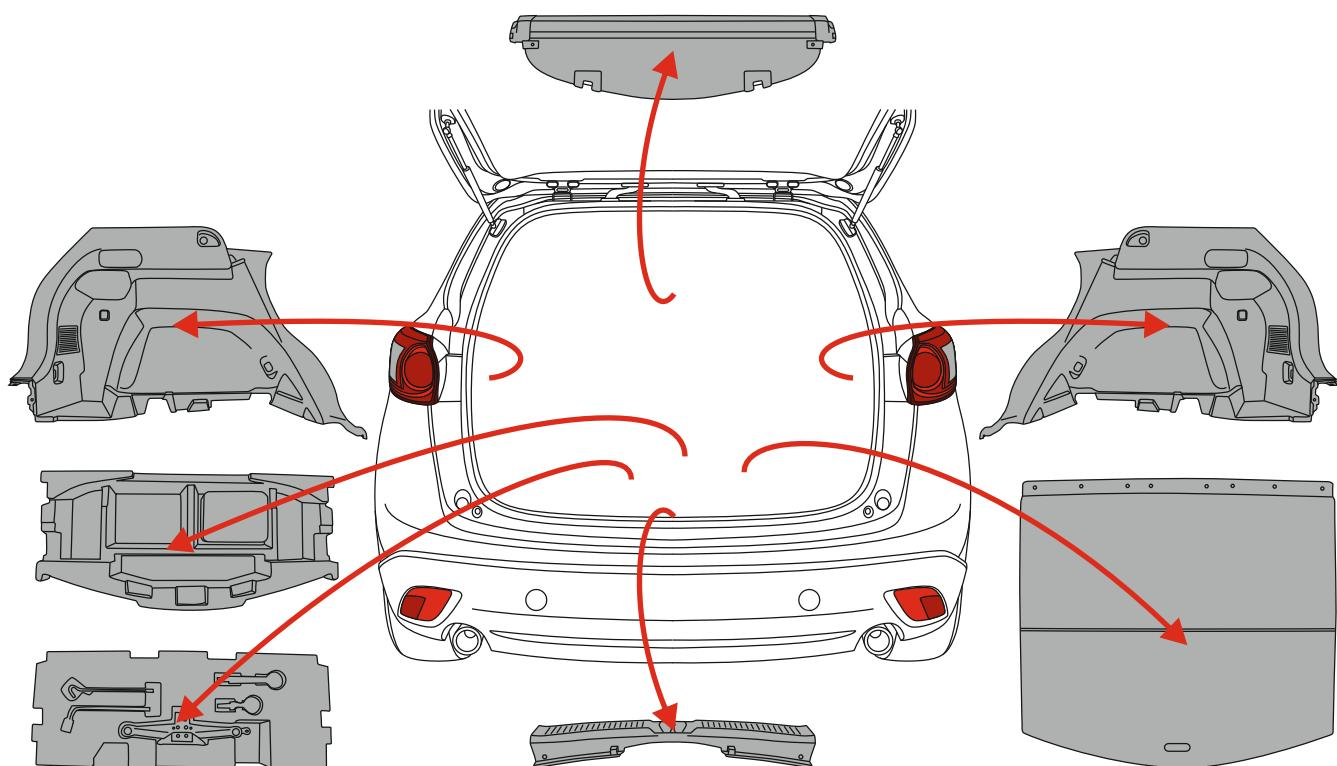
Элементы обшивки, которые рекомендуем демонтировать перед установкой комплекта проводки.
