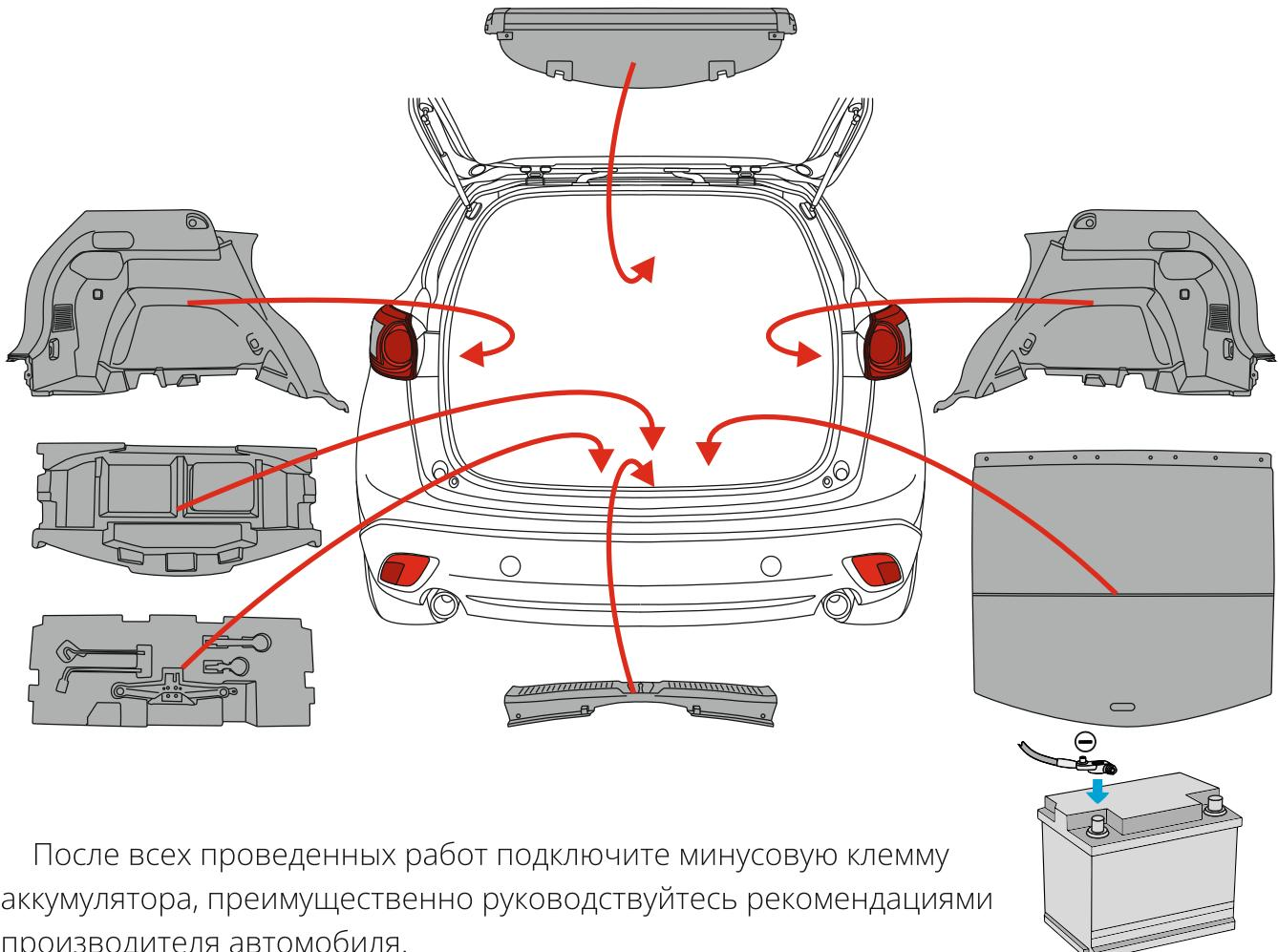
После всех проведенных работ подключите минусовую клемму аккумулятора, преимущественно руководствуйтесь рекомендациями производителя автомобиля.
