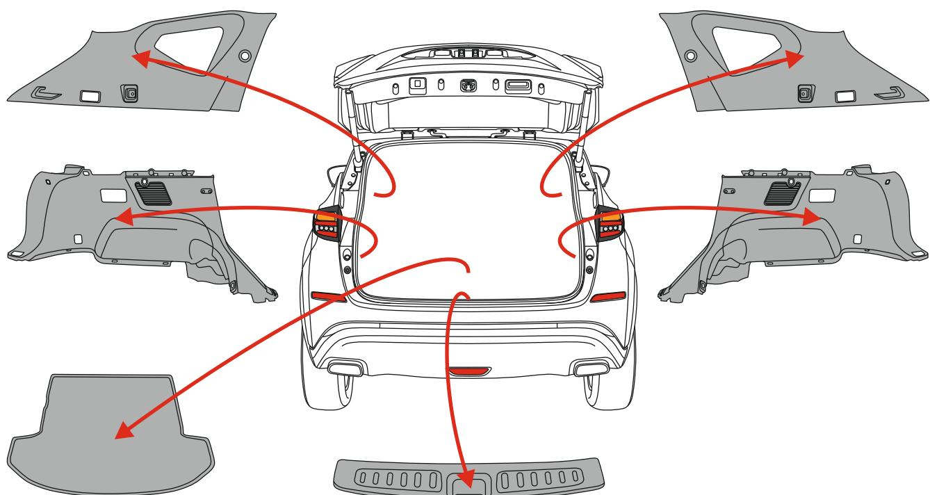
Элементы обшивки, которые рекомендуем демонтировать перед установкой комплекта проводки.
