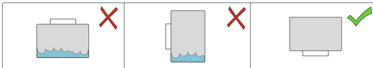
Блок устанавливать строго вниз разъемом во избежание скопления конденсата.
