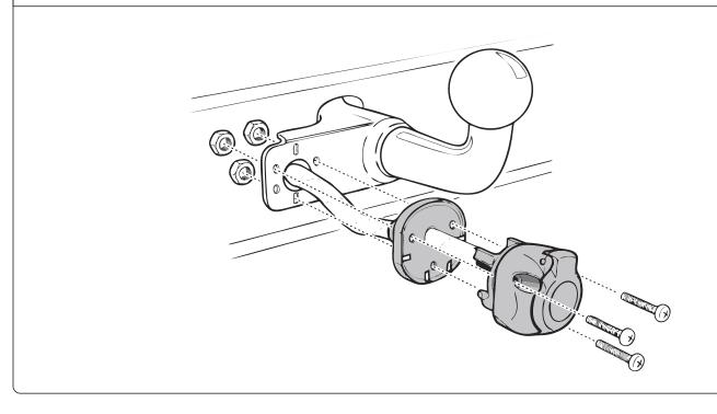
После монтажа проведите проверку правильности присоединения электропроводки тестером с нагрузкой или лампами соответствующей мощности. Сборку производите в обратном порядке.
