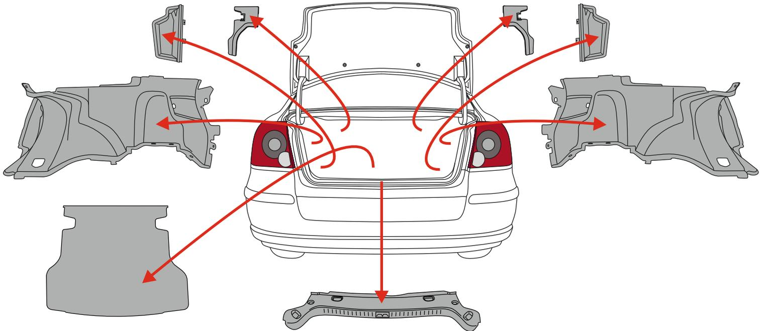
Элементы обшивки, которые рекомендуем демонтировать перед установкой комплекта проводки.
