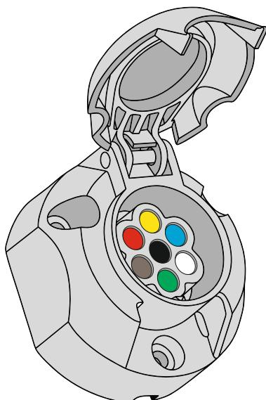
Проведите проверку сигналов, выходящих на розетку тягово-сцепного устройства при запущенном, а затем - на заглушенном двигателе автомобиля.
