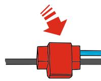
5. Зафиксируйте «зажим» сверху пластиковым изолатором до щелчка.
