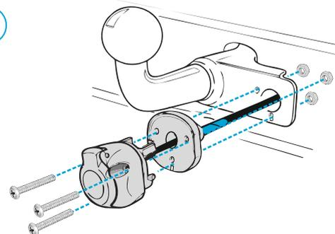
Закрепите розетку и пыльник на монтажной поверхности.
