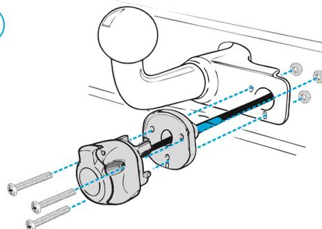
Закрепите розетку и пыльник на монтажной поверхности.
