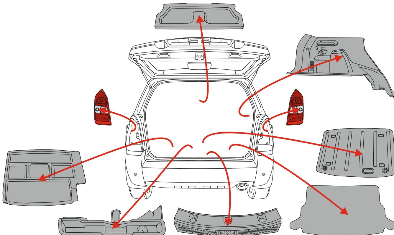
Элементы обшивки, которые рекомендуем демонтировать перед установкой комплекта проводки.
