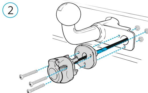
Закрепите розетку и пыльник на монтажной поверхности.
