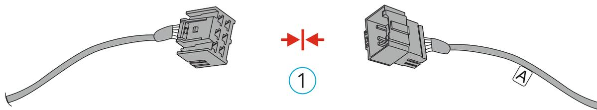
Соедините колодку из комплекта до щелчка в порядке, указанном на рисунке. Надежно закрепите.
